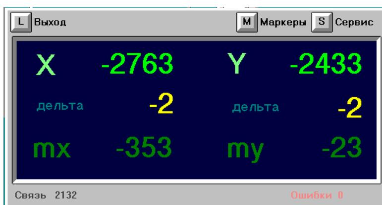
На этом экране отображаются: Координаты датчиков (они обозначаются буквами X Y); Расхождения между координатами системы ЧПУ и координатами датчиков (дельта) и Координаты маркеров (контрольных точек на линейных преобразователях – mx, my).
