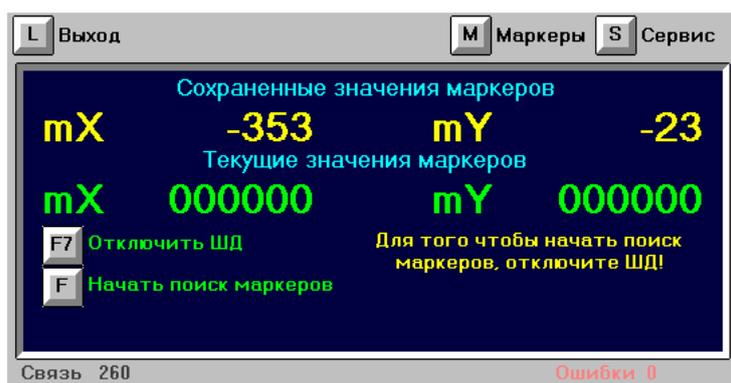
В этом режиме на экране отображаются: предыдущие (сохраненные) координаты маркеров и текущие (только что найденные) координаты. В правой нижней части экрана даны инструкции по поиску маркеров.
